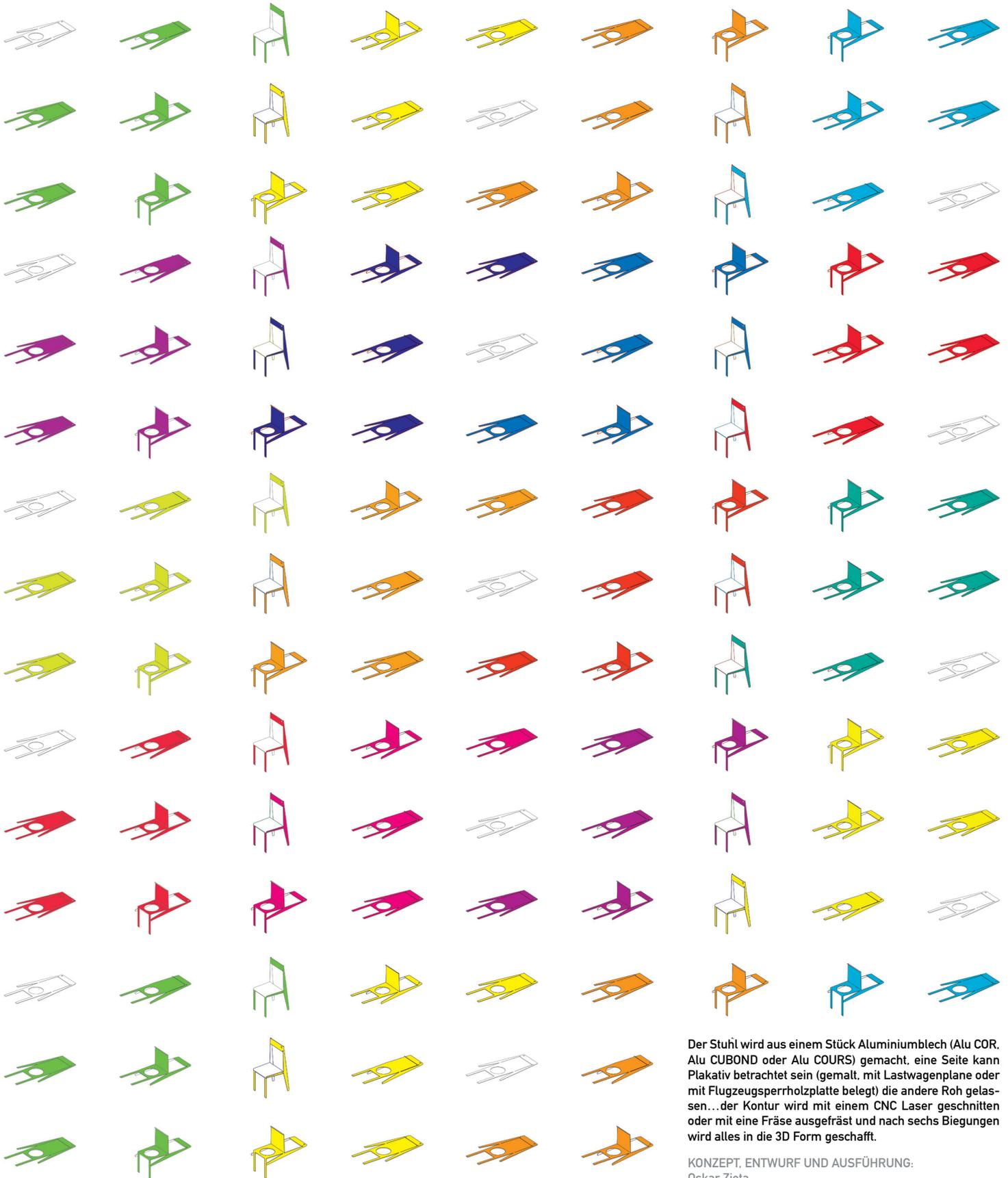
Der Stuhl wird aus einem Stück Aluminiumblech (Alu COR, Alu CUBOND oder Alu COURS) gemacht, eine Seite kann Plakativ betrachtet sein (gemalt, mit Lastwagenplane oder mit Flugzeugsperrholzplatte belegt) die andere Roh gelassen...der Kontur wird mit einem CNC Laser geschnitten oder mit eine Fräse ausgefräst und nach sechs Biegungen wird alles in die 3D Form geschafft.
