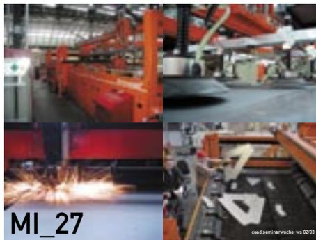
Die Umwandlung des Entwurfs in detaillierte Bauteile erfolgt mit Software: Die Formen der einzelnen Bauteile werden eingelesen und automatisch mit Laschen, Bohrlöchern, Aussparungen etc. versehen. Die Software wird von den Teilnehmern programmiert. Mit ihrer Hilfe gelingt es, sich den einzelnen Entwurfsvarianten schnell anzupassen.
