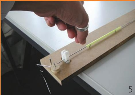
Das Biegen geschieht in einem sich wiederholenden Prozess, der aus zwei Bewegungsabläufen (Vortrieb + Verformung) besteht, die wiederum grob in insgesamt fünf Unterschritte unterteilt werden können.
