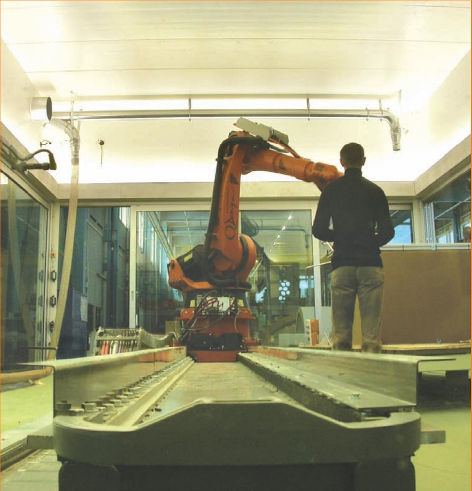
Die Linearinheit erhöht die Flexibilität des Roboters und vergrößert seinen Arbeitsraum.
