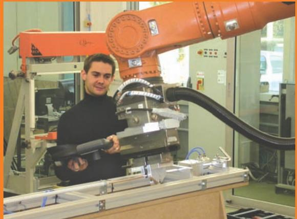
Beim Positionieren des Rohrs für die nächste Biegung reicht der Platz manchmal nicht aus, so dass der Roboter nachgreifen muss. Dies wird allerdings im Skript berücksichtigt und automatisch veranlasst.
