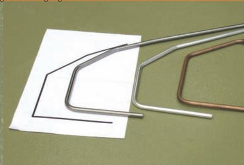
Unterschiedliche Metalle: Kupfer, Aluminium, Stahl; Rechts: Referenzstücke um die Einstellungen zu testen.
