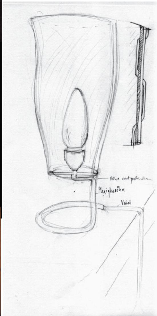
Die Lampe besteht aus einem Schirm und einem biegbaren Stab, der als Fuss und Nahtverbindung des Schirmes dient.
