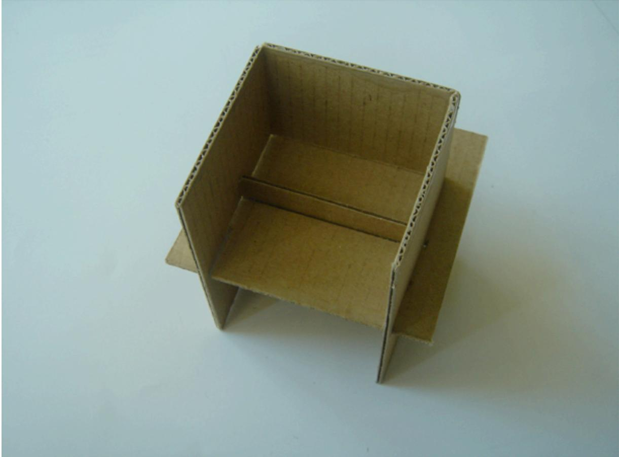
Die Ecke wird durch zwei Steckelemente in alle Richtungen ausgesteift und garantiert so die Stabilität der Hülle.
